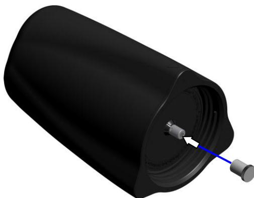
Из использованного картриджа могут вытекать чернила. Наденьте на клапан картриджа **31** транспортную заглушку, чтобы чернила самопроизвольно не вытекали. Идет в комплекте с картриджем.
