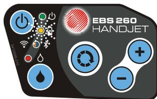
При значительном разряде аккумулятора раздается звуковой сигнал **34** (при условии настройки соответствующего сигнала – см. [Настройка звука](#) (с. **24**)) и появляется значок (G) на экране **12**. Крайняя степень разряда (менее 5%) сопровождается очень быстрым равномерным
